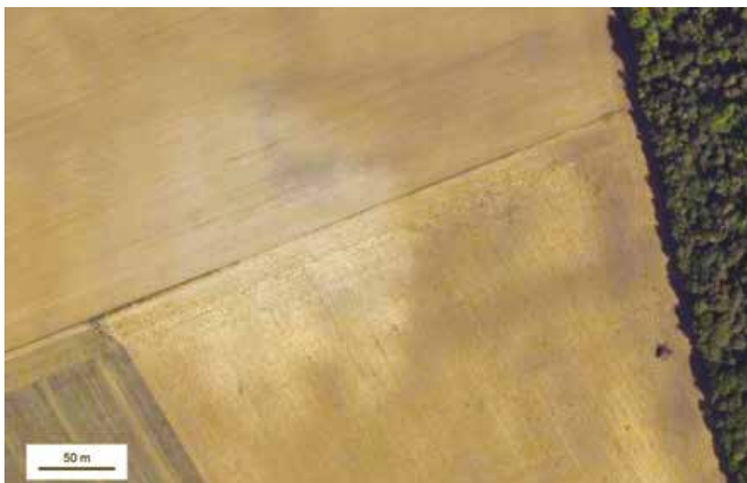
Fig. 30 – Mécrin « La Charpentière». Halde de la minière matérialisée sur le terrain labouré par des rejets de calcaire blanc (©IGN géoportail).
