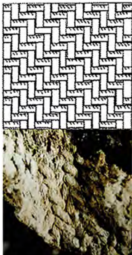
Fig. 16 – Exemple d'armure sergé.
